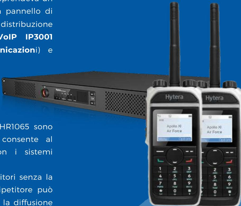
I ripetitori DMR della serie Hytera HR1065 sono dotati di un'interfaccia SIP, che consente al sistema radio di interfacciarsi con i sistemi telefonici VoIP.
