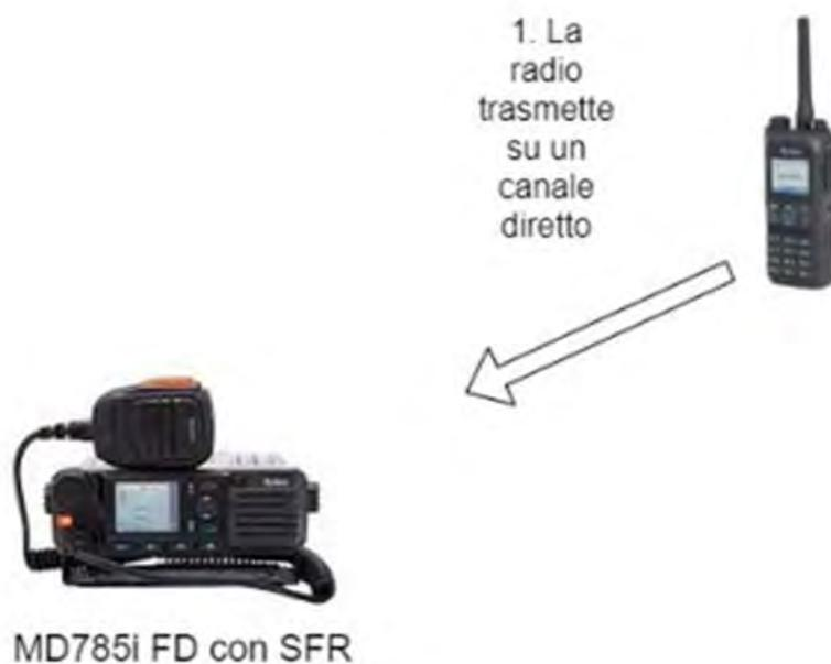
2a) La radio MD785i Full Duplex ritrasmette la comunicazione sul secondo slot della diretta e in questo modo una radio che non era in copertura riesce a ricevere le informazioni trasmesse
